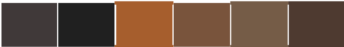
RAL 8019 RAL 8022 RAL 8023 RAL 8024 RAL 8025 RAL 8028 Pardo grisáceo Pantone ≈412 Pardo negruzco Pantone ≈Black6 Pardo anaranjado Pantone ≈471 Pardo beige Pantone ≈4705 Pardo pálido Pantone ≈4705 Marrón tierra Pantone ≈4695
