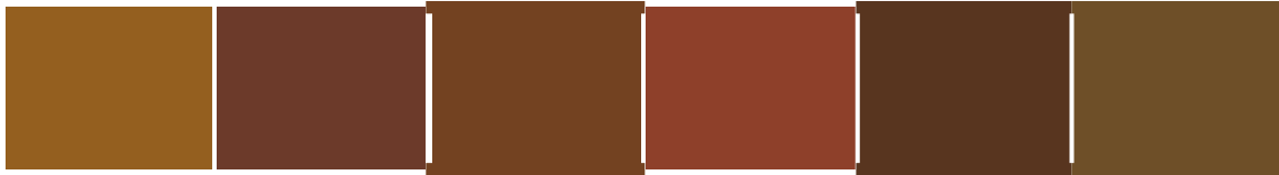
RAL 8001 RAL 8002 RAL 8003 RAL 8004 RAL 8007 RAL 8008 Pardo ocre Pantone ≈471 Marrón señales Pantone ≈478 Pardo arcilla Pantone ≈4635 Pardo cobre Pantone ≈4635 Pardo corzo Pantone ≈478 Pardo oliva Pantone ≈463
